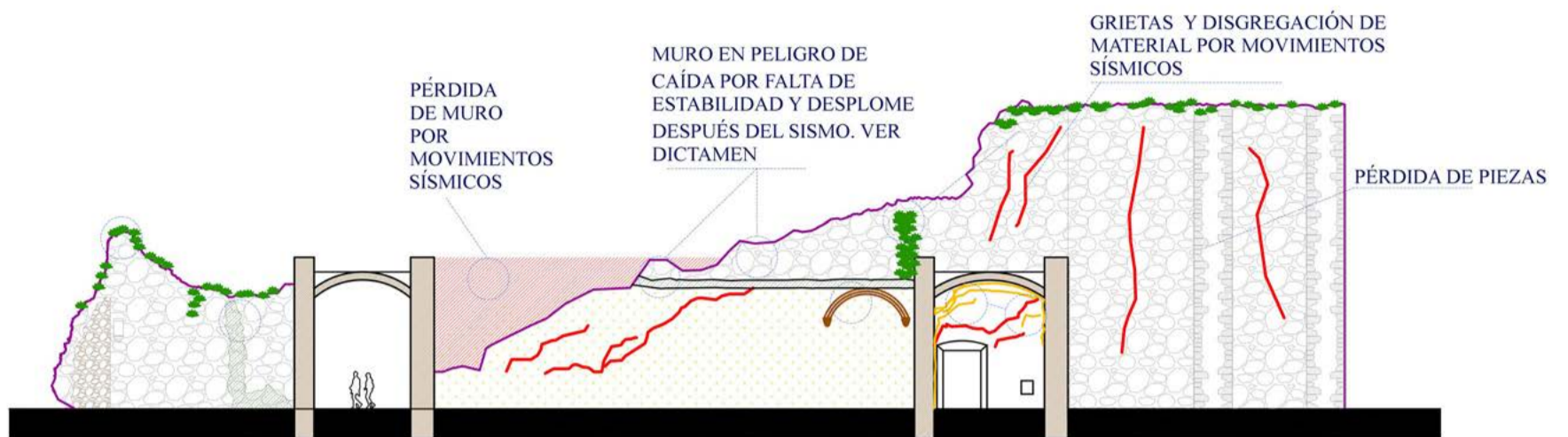
Figura 4. Levantamiento de daños, muro sur de la nave del templo. Fuente: elaboración propia.
