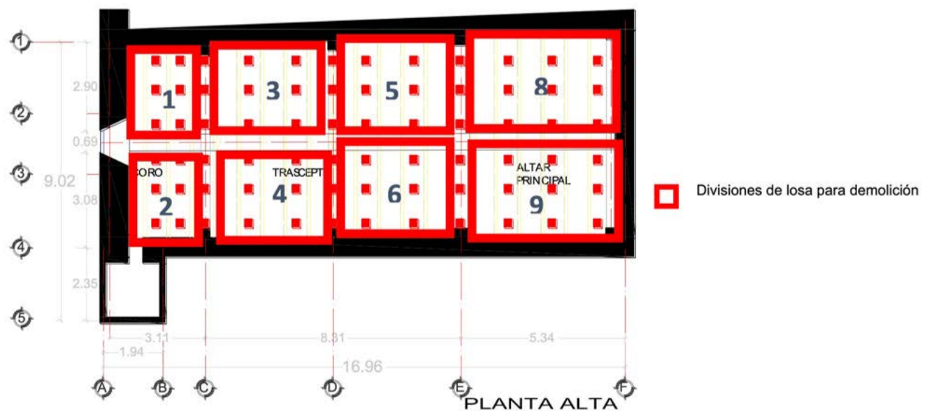
Imagen 7. Vista de la división de una losa. Fuente: elaboración propia.
